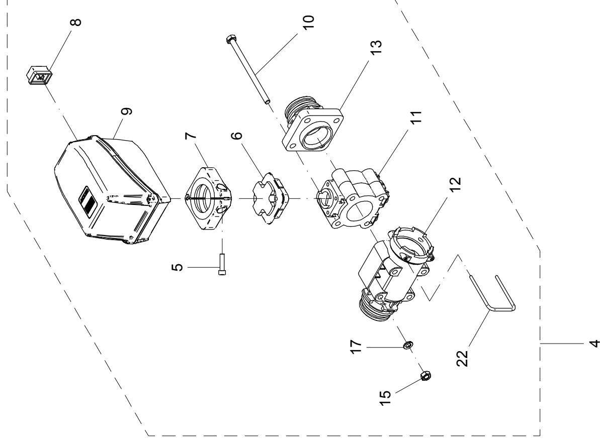
1107 - FLUXÔMETRO E VÁLVULA DE COMANDO ARAG
