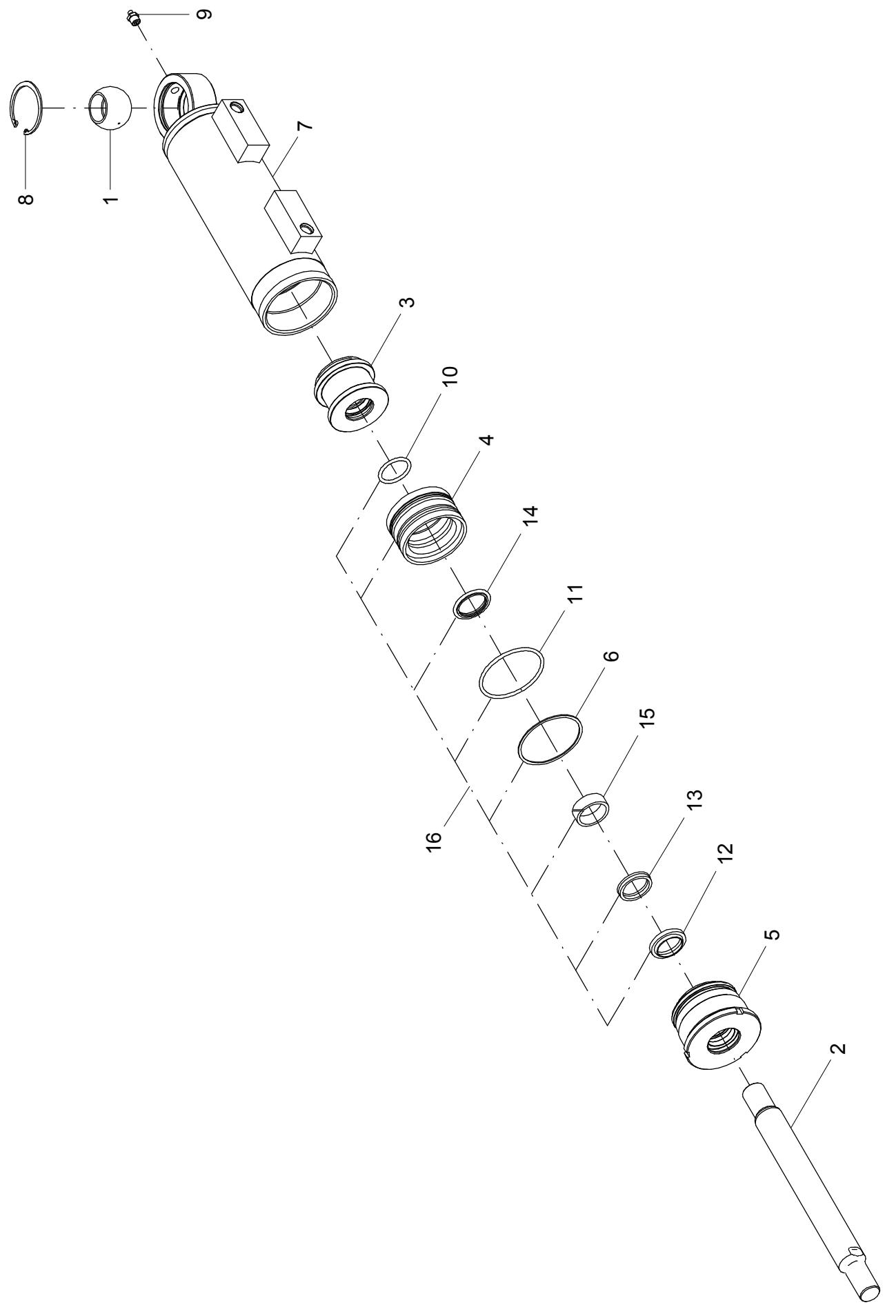
82 – CILINDRO HIDRÁULICO DE DIREÇÃO – 28805400
