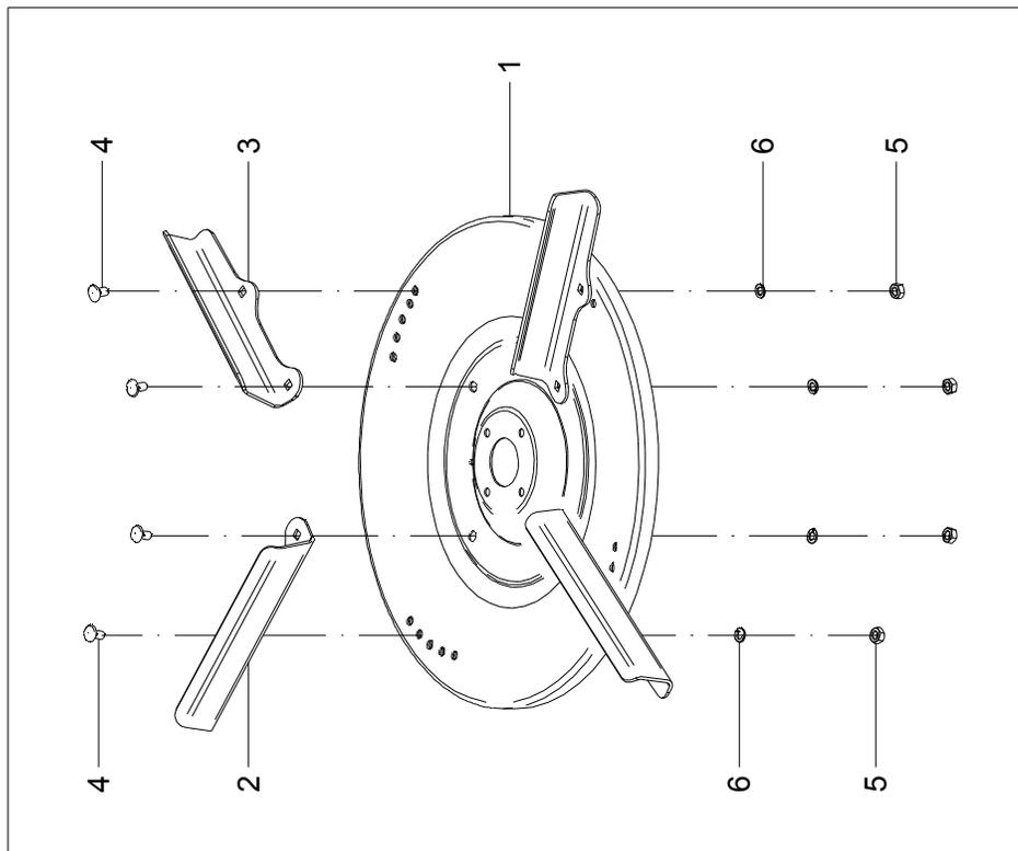
**Montagem para fertilizante:** 2 palhetas intermediárias esquerdas
