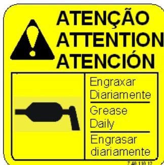
Código: 74011012: Mantenha a lubrificação para evitar desgaste prematuro dos componentes.
