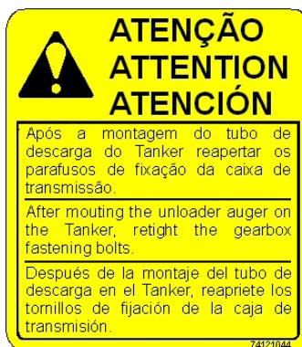
Código: 74121044: Após montar o tubo reaperte os parafusos da caixa de transmissão.
