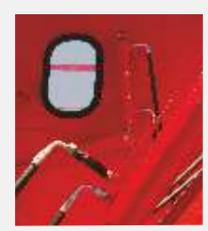
Sistema de regulación de descarga a través de apertura y cierre de las canaletas internas de control del flujo del producto por intermedio de palancas, ubicadas en la parte frontal del estanco. The unloading adjustment system is realized by opening and closing the internal chutes which control the product flow through external levers placed on the front deposit tank;
