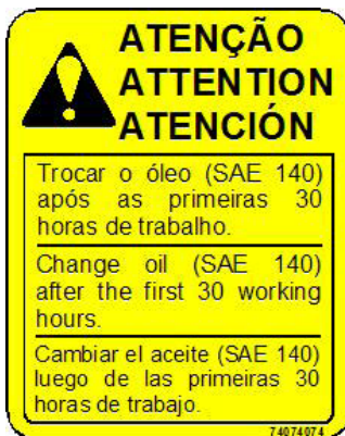
Código 74074074: Troque o óleo da caixa de transmissão após as primeiras 30 horas de trabalho.
