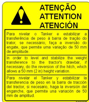
Código 74121037: Para estabilização de peso à barra tração do trator, se necessário, inverter o engate.
