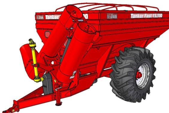
O Tanker destina-se a transferência de grãos, sementes e fertilizantes. O produto é conduzido para o tubo de descarga por gravidade. Dentro do tubo existe um helicóide que eleva os grãos para a descarga.
