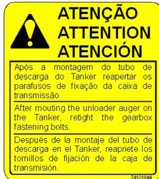
Código 74121044: Reaperte os parafusos de fixação da transmissão após montagem do tubo de descarga.
