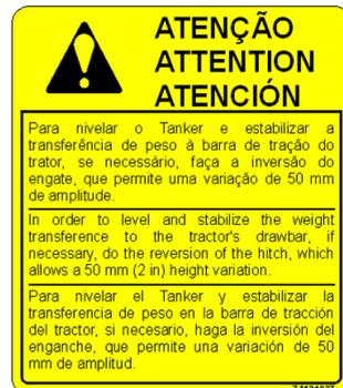
Código 74121037: Para estabilização de peso à barra tração do trator, se necessário, inverter o engate.
