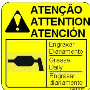
Código 74011012: Mantenha a lubrificação do Tanker Fast para evitar desgaste prematuro de componentes.
