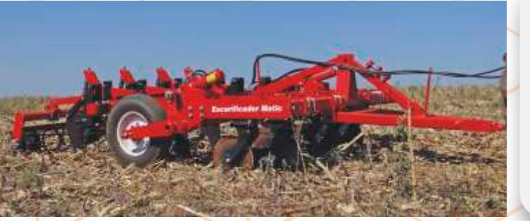
Es compuesto de un sistema de seguridad que desarma el brazo a través de un resorte llano, siempre que el mismo encontrar algún obstáculo. Para rearmar es automático, basta sostener el escarificador, tornando la manutención del sistema una operación simple y por consecuencia obteniendo mayor rendimiento y menor costo operacional;
