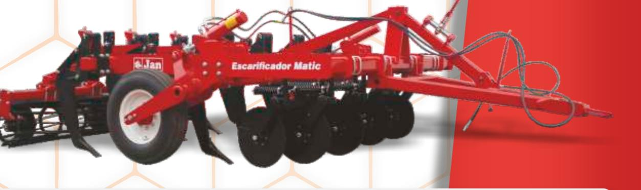
El escarificador efectúa el rompimiento de la camada compactada del suelo sin ocasionar excesivo revolviendo, mantiene la mayor parte de los residuos vegetales en la superficie, mejorando la porosidad y la infiltración del agua.
