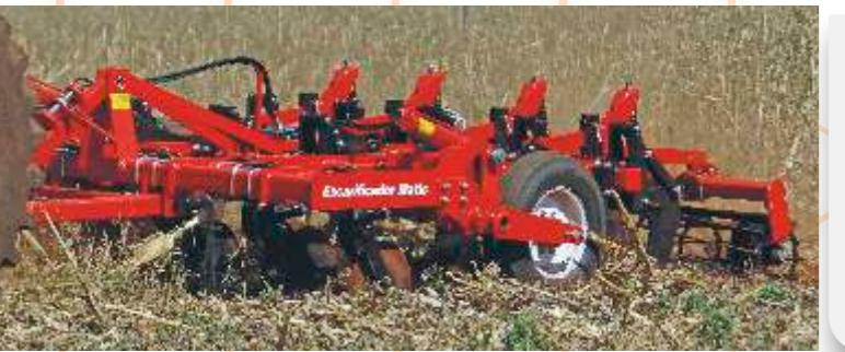
El disco de corte posee regulación vertical a través de un mancal deslizante y de fácil regulación, con resorte helicoidal, que permite al disco acompañar las ondulaciones del terreno. Su mecanismo ofrece mayor efectividad de corte sin, comprometer la profundidad de trabajo del brazo;
