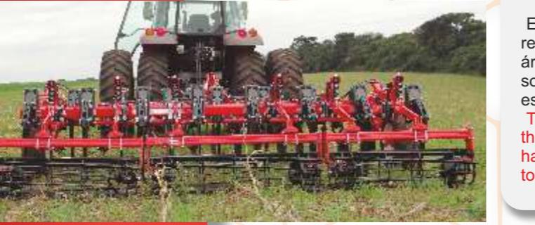
El rodillo destrozador acompaña la topografía del terreno reduciendo el tamaño de los turrones y nivelando la superficie del área escarificada. Es equipado con mancales bañado de aceite, soportes articulados y resortes helicoidales para garantizar la estabilidad del conjunto.
