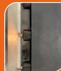
**ESTEIRA DE BORRACHA COM ROLOS DE TECNIL ENCAIXADOS SOB O CHASSI DA ESTEIRA.**
