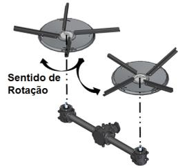
O sistema de distribuição é composto por dois discos de distribuição confeccionados em chapa inox, com quatro palhetas em cada disco, contendo cinco opções de regulagem angular, com posições intermediárias.
