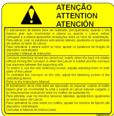
Código: 74031123 - Tensionamento da esteira.
