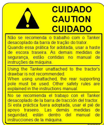
Código: 74121041 - No se recomienda trabajar con la máquina desacoplada de la barra de tracción del tractor.
